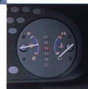
Avec la transmission CVT, le mode sélectionné est lisible au tableau de bord
